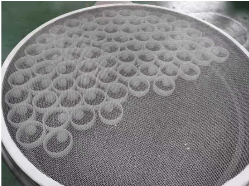
超声波筛分系统是一种简单实用、可靠的筛分系统，是当前网孔堵塞的有效的解决方法。可广泛应用于制药、冶金、化工、选矿、食品等要求精细筛分过滤的行业，筛分过滤精度高，有效解决因团聚、静电、强吸附性卡堵网孔等筛分难题，是国内筛分行业的一项重大技术突破。上海超声波发生器超声波系统外置超声波发生器厂家：外置超声波系统参数：电源输入：交流 $220V$  $10\%50\sim60Hz$ 整机电流 $\leq 0.5A$ 高频电流 $\leq 0.4A$ 工作频率 $37KHz$ 双频。工作模式：双频振动环境温度： $-10\sim60^{\circ}C$ 设备功率 $80-120W$ 筛砂机功率多少，产量高不高，能用几年？余盈给您定制！上海不锈钢振动筛分机供应商
