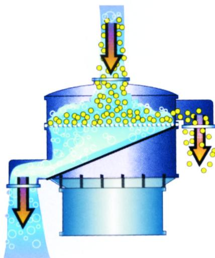
超声波筛分系统是一种简单实用、可靠的筛分系统, 是当前网孔堵塞的有效的解决方法。可广泛应用于制药、冶金、化工、选矿、食品等要求精细筛分过滤的行业, 筛分过滤精度高, 有效解决因团聚、静电、强吸附性卡堵网孔等筛分难题, 是国内筛分行业的一项重大技术突破。上海
